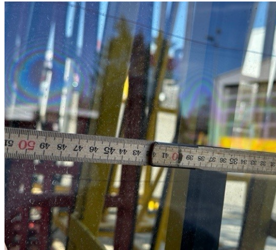
Mehrere Interferenzerscheinungen in einem MIG
